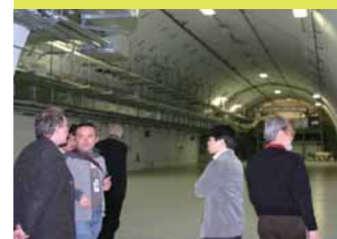
LCLSの実験ホールの内部。トンネルの内寸は幅15m、長さ80m、高さ10mあり、SCSS試験加速器(日本のXFELのプロトタイプ機)を5セット以上並べることが可能。
